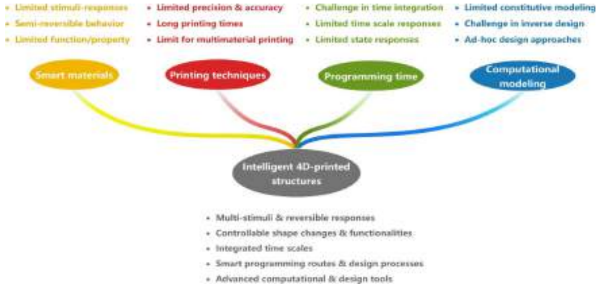
الشكل 7 مخطط يتعلق بالهياكل المطبوعة ثلاثية الأبعاد الذكية. [14]
