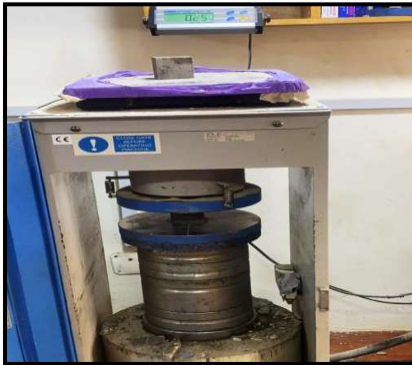
شكل (14) اختبار مقاومة الضغط.
